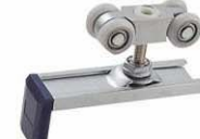
Model: 303 珍珠铬 材质: 锌合金橡胶轮 选用: 高速精密轴承 承重量: 50kg 适装门宽: 650-850mm 适装, 门厚: 35-45mm
