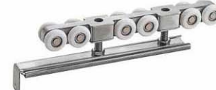
Model: 312 不锈钢 材质: 锌合金橡胶轮 选用: 高速精密轴承 承重量: 80kg 适装门宽: 650-850mm 适装, 门厚: 10-12mm
