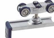
Model: 302 珍珠铬 材质: 锌合金橡胶轮 选用: 高速精密轴承 承重量: 50kg 适装门宽: 650-850mm 适装, 门厚: 35-45mm
