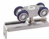
Model: 301 拉丝钢 材质: 锌合金橡胶轮 选用: 高速精密轴承 承重量: 50kg 适装门宽: 650-850mm 适装, 门厚: 35-45mm
